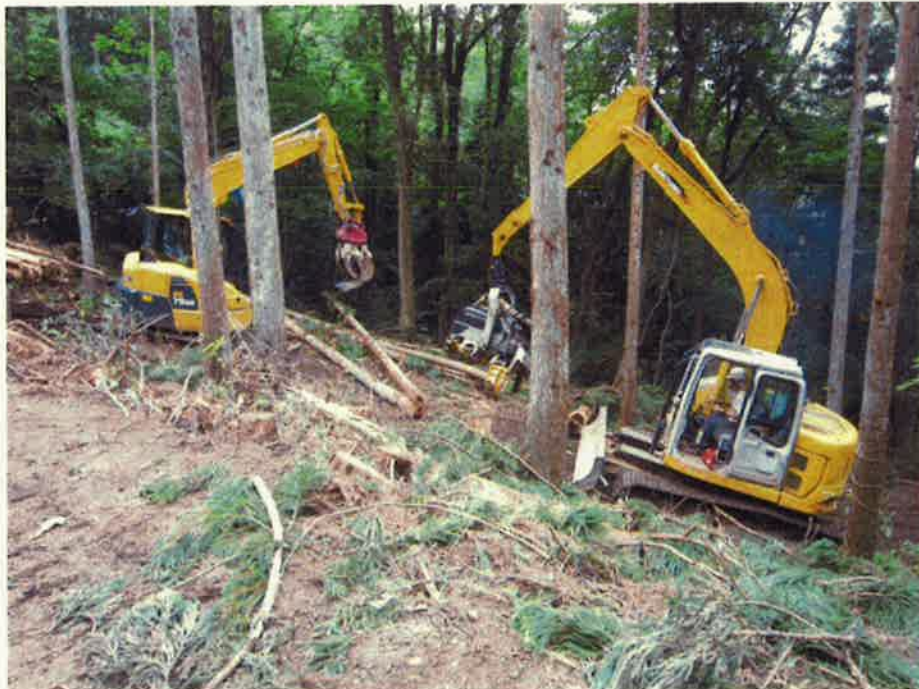
高性能林業機械を用いた間伐作業（長浜市木之本町黒田）
