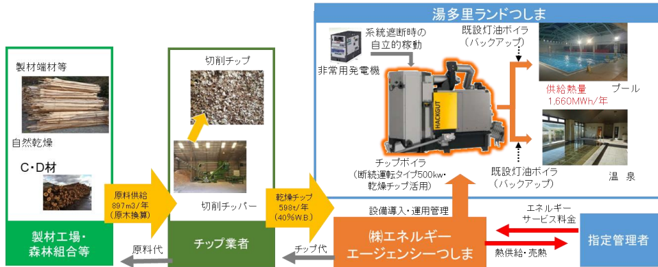
図 エネルギーエージェンシーつしまの ESCO 型熱供給サービス
