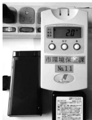
▲これが小型電力計。コンセントの間にはさむと電力を測定します。待機電力や電源を入れたとき・強さを変えたときなど、いろいろな電力を測定してみてください！
