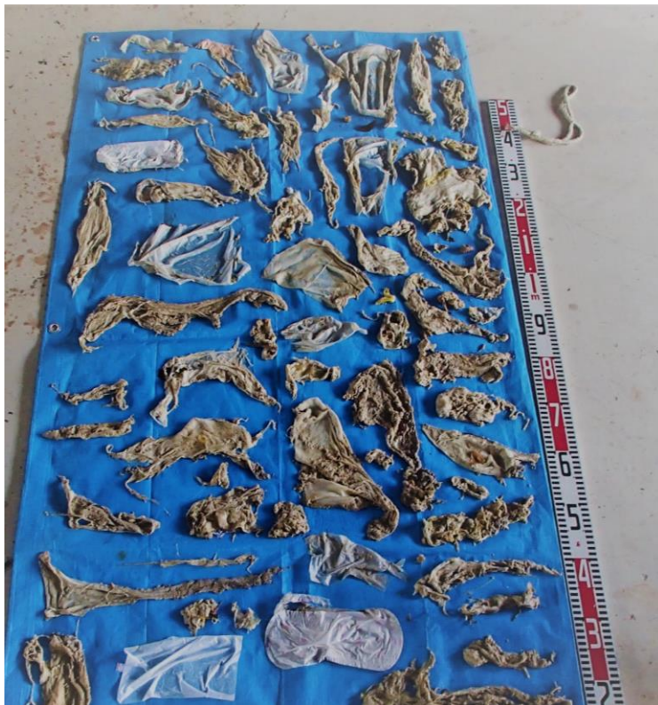
下水道に流れ込んだ異物
