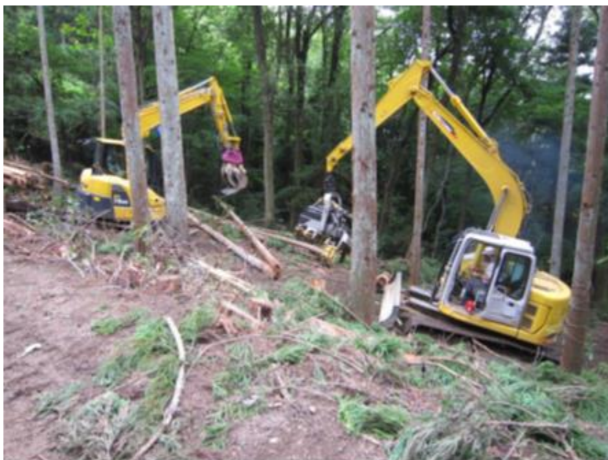
高性能林業機械を用いた間伐作業（木之本町黒田）
