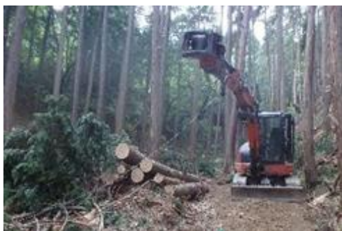
グラップルによる搬出作業
