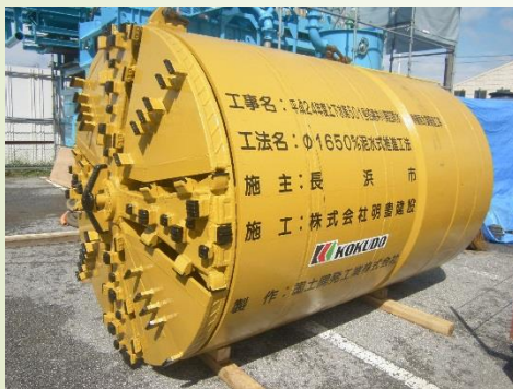
的場井川 掘進機
