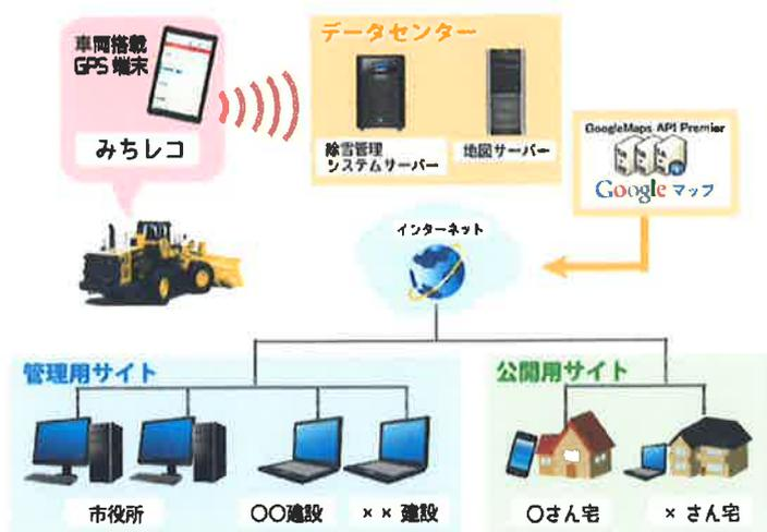
また、作業後の稼働履歴による作業日報の自動入力機能が備わっており、機械別の除排雪委託料の積算を自動で行うことが可能です。
