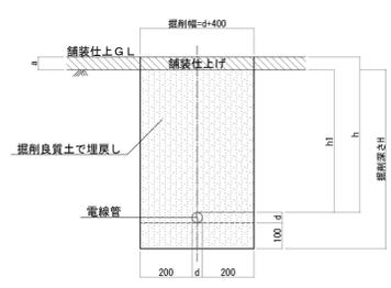
電線管理埋設断面図 (7x7x11舗装部)
