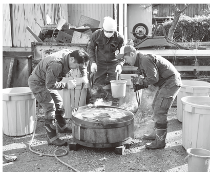
▲曳山車輪鉄輪修理(焼き嵌め)の様子
